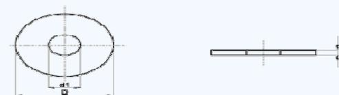
**M 2** : d1 2,2 X D 7,0 X h 0,5 mm
