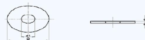
**M 2** : d1 2,2 X D 4,0 X h 0,5 mm
