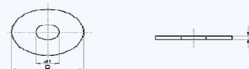
**M 2** : d1 2,2 X D 5,0 X h 0,3 mm
